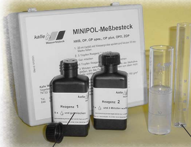
Meßröhre mit schwarzem Fadenkreuz am Boden und Skalierung für Dosiermittelgehalt.
